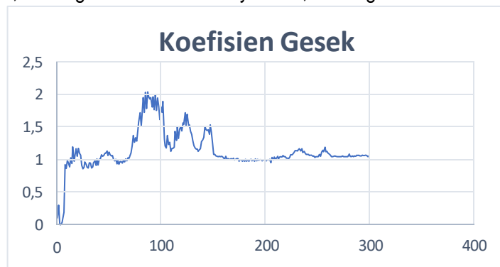
Gambar 3.9 grafik koefisien gesek variasi setengah coating percobaan ketiga.
