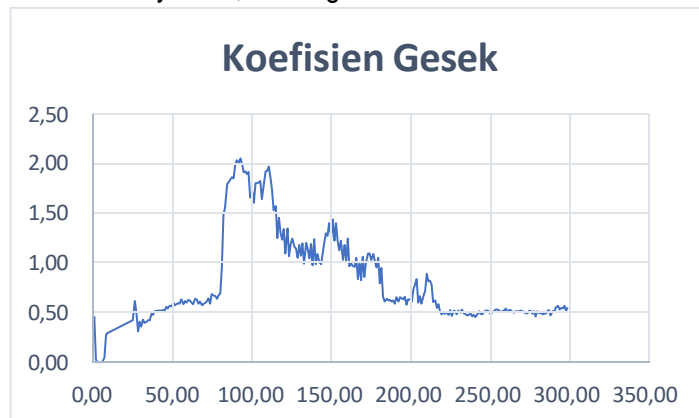
Gambar 3.14 grafik koefisien gesek variasi 1 coating percobaan kedua.
