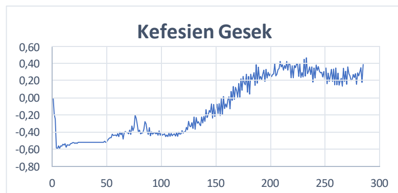
Gambar 3.1 grafik koefisien gesek variasi tanpa coating percobaan pertama.
