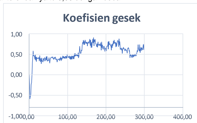
Gambar 3.20 grafik koefisien gesek variasi 2 coating percobaan kedua.
