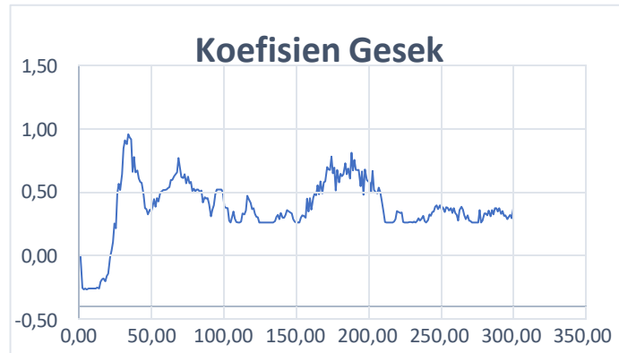
Gambar 3.8 grafik koefisien gesek variasi setengah coating percobaan kedua.
